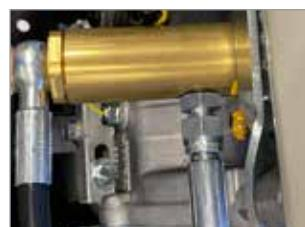
LA VERSION "GD" EST EQUIPÉE D'UN DÉCÉLÉRATEUR HYDRAULIQUE PERMETTANT UNE MEILLEURE LONGÉVITÉ
