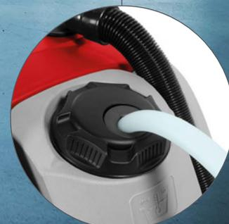
Prêt à l'emploi en un rien de temps, grâce au chargement rapide de l'eau propre qui a lieu via la fissure avec filtre située sur le bouchon de chargement avant de Vispa XL.
