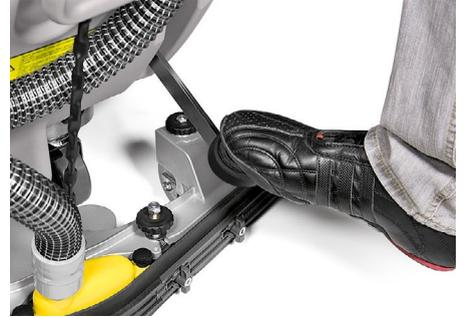
La chaîne d'abaissement du suceur est robuste, elle est réalisée en acier et munie d'une poignée ergonomique en aluminium moulé sous pression
