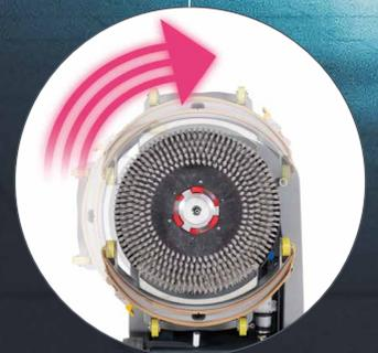
Le suceur pivote de 180°, dans la position latérale il est possible d'effectuer les opérations d'entretien et de remplacement facile et rapide des brosses. Le suceur peut sécher même en marche arrière ce qui rend les opérations de nettoyage encore plus simples.
