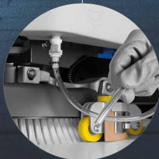
Même le déchargement de l'eau présente dans le réservoir de solution peut être effectué rapidement et facilement grâce au tuyau de déchargement spécial qui peut être accroché à l'avant de l'autolaveuse.
