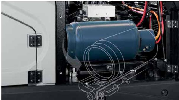
La zone des moteurs est facilement accessible. La version Bi-fuel dispose d'un compartiment spécifique pour loger la bouteille GPL.
