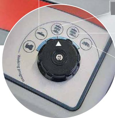
Utiliser la C130 devient extrêmement simple, intuitif et pratique. Le sélecteur des programmes de travail permet de choisir manuellement le type d'activité que l'on veut exécuter : lavage et séchage, lavage et séchage avec déplacement latéral du groupe brosses ou lavage seul ou séchage seul.
