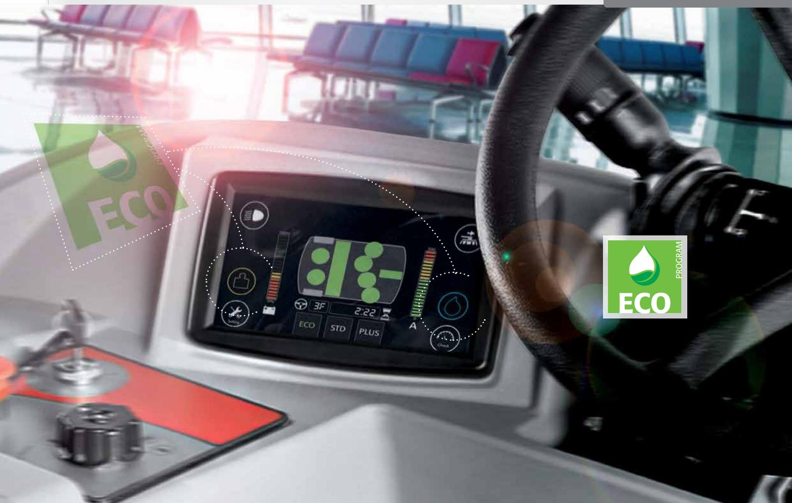
La C130 adopte des technologies qui aident à économiser les ressources. En effet, si l'on exécute des opérations de nettoyage en mode ECO, la distribution d'eau, de détergent et de pression sont réduites au minimum.
