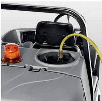
Un simple dispositif (en option) permet de remplir rapidement le réservoir d'eau propre, sans la présence de l'opérateur
