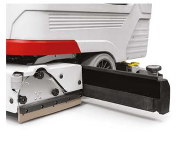
La version de brosseage (BTS) est équipée d'un bac de ramassage des petits résidus solides. Il est possible de le vider facilement en le dégageant latéralement
