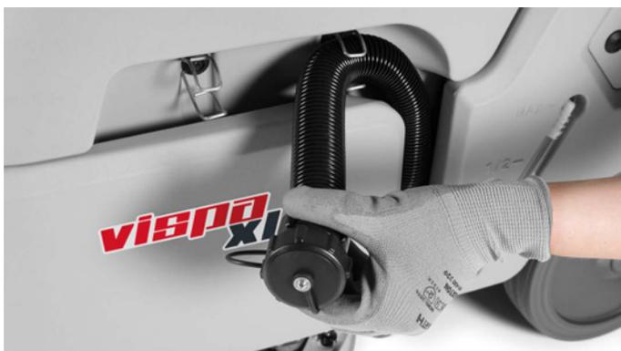
L'entretien, même extraordinaire, est plus simple grâce à l'accessibilité complète des composants. Le réservoir de récupération est doté d'une poignée pratique pour faciliter son soulèvement et le vidage. Pour faciliter encore plus cette opération, le réservoir d'eau sale de Vispa XL peut également être vidé via le tube latéral.
