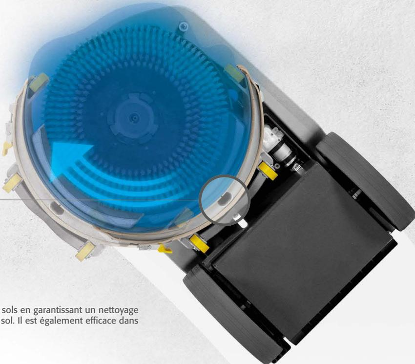
Le mouvement du carter orbital permet de nettoyer différents types de sols en garantissant un nettoyage parfaitement uniforme, car le tampon reste toujours en contact avec le sol. Il est également efficace dans de nombreuses situations, même sans l'usage de produits chimiques
