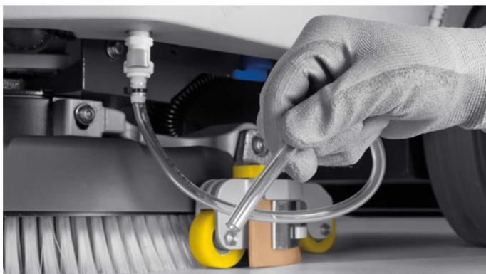
Même le vidage du réservoir de solution peut être effectué rapidement et facilement grâce au tuyau de déchargement spécial qui peut être accroché à l'avant de Vispa XL.
