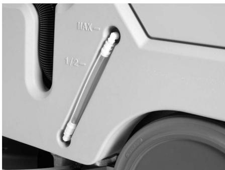
Le niveau de solution présente dans l'autolaveuse est toujours visible grâce à l'indicateur transparent situé sur le côté de Vispa XL.
