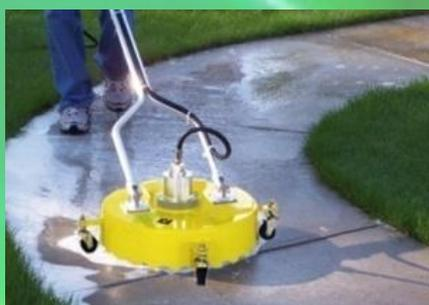
Equipé d'un bras rotatif situé proche du sol de buses à angle large pour un rendement maximal et un nettoyage en profondeur de la surface à traitée. Système anti projection d'eau pour un meilleur confort d'utilisation
