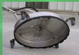
. Il est recommandé de calculer le diamètre des jets suivant le modèle du nettoyeur, le calibre de la buse sera divisé par deux avec un angle large de 40°. Les lances de sols peuvent être en abs, acier ou inox et le diamètre de la cloche au sol varie selon la surface à nettoyer.
